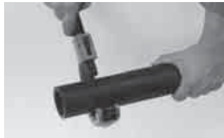
1. Pulire i tubi, tagliare ad angolo retto, eliminare possibili sbavature.
