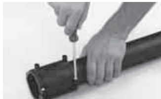
6a. Infilare il raccordo sul tubo sino al riferimento contrassegnato oppure fino al fermo centrale e stringere le due viti dei collari posizinatori integrati.
